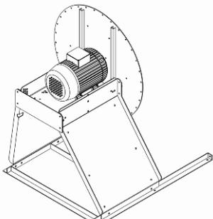
1. Stativplattor med brickor och motor på basramen
