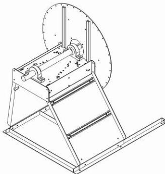
1. Stativplåt med brickor, sockellager och axel på basramen - skruva fast
