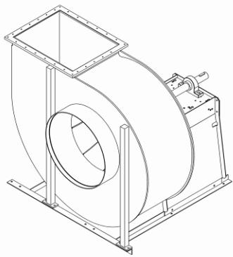
4. Skruva fast stödfästet på basramen.
