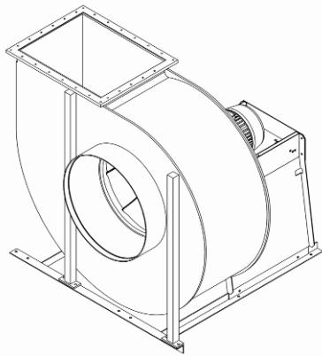
4. Skruva fast stödfästet på basramen.
