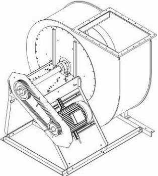
5. Motor med spännskenor, remskyddsplåt och kilremsdrift, montera
